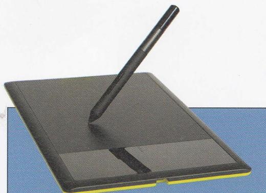
↑ **TABLETĂ GRAFICĂ** Acestea nu sunt, de fapt, ecrane tactile, dar le permit ilustratorilor și proiectanților să „deseneze” cu un creion magnetic pe o tabletă și să vadă imediat rezultatele pe monitor. Tableta conține o rețea de fibre conductoare care primesc stimulii de la vârful magnetic al creionului.
