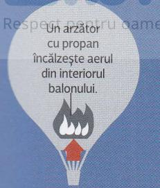
Un arzător cu propan încălzește aerul din interiorul balonului.
